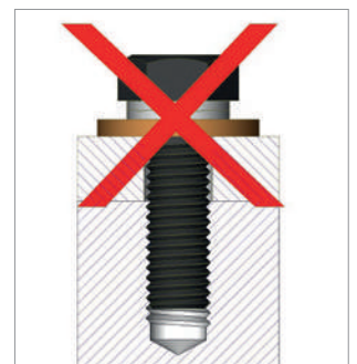
Sin función de seguridad en combinación con arandelas que giran libremente
