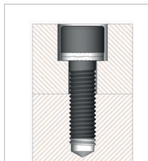
Tornillo cilíndrico asegurado en un agujero ciego
